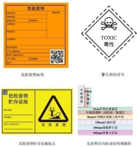
图 5-1 危废暂存间标识
